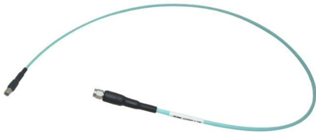
要注意观察接头和电缆连接部位的工艺, 这会影响到射频电缆的使用寿命。在这个部位, 传统的电缆和接头之间有一个硬接触点, 很容易造成电缆的断裂, 这也是大部分测试工程师在使用传统测试电缆测试过程中至头疼的问题, 而这并不是简单采用热缩套管就可以解决的, 因为这种硬接触点的断裂往往是测试电缆在频繁弯折后, 张力通过电缆传导到硬接触点, 造成硬接触点老化而断裂。传统不带铠装的柔性测试电缆自不用说, 由于没有铠装层的保护, 即使在电缆和接头连接处采用增强型的热缩套管也不能有效延长测试电缆的使用寿命; 而传统的铠装电缆由于铠装层之间以及铠装层和信号传输层之间有间隙, 张力还是会在电缆弯折后传导到硬接触点, 造成电缆在使用一段时间后指标发生跳变
