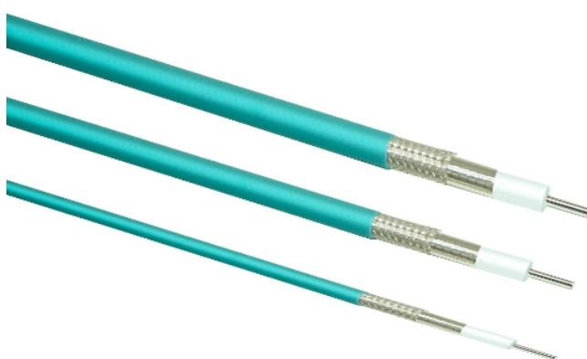
射频电缆也叫同轴电缆，是由互相同轴的内导体、外导体以及支撑内外导体的介质组成的。对称射频电缆回路其电磁场是开放型的，由于在高频下有辐射电磁能，因而使衰减增大，并导致屏蔽性能差，再加上大气条件的影响，通常较少采用。对称射频电缆主要用在低射频或对称馈电的情况下。螺旋射频电缆：同轴或对称电缆中的导体，有时可做成螺旋线圈状，借以增大电缆的电感，从而增大了电缆的波阻抗及延迟电磁能的传输时间，前者称为高阻电缆，后者称为延迟电缆。如果螺旋线圈沿长度方向卷绕的密度不同，则可制成变阻电缆。不同的应用场合应选择不同类型的射频电缆。KBC系列测试级射频电缆制造商
